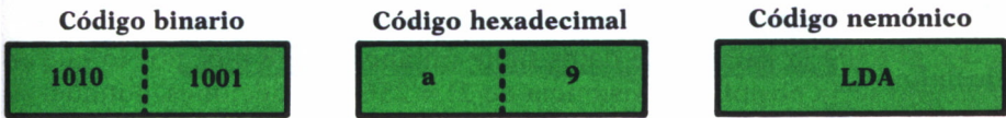
Fig. 2.10. Tres formas de expresar la instrucción de “Carga del Acumulador” mostrando la evolución del lenguaje máquina.
