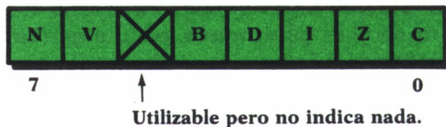
Fig. 2.6. Estructura de los bits del registro de Estado, que actúan como señalizadores o alarmas (flags).
